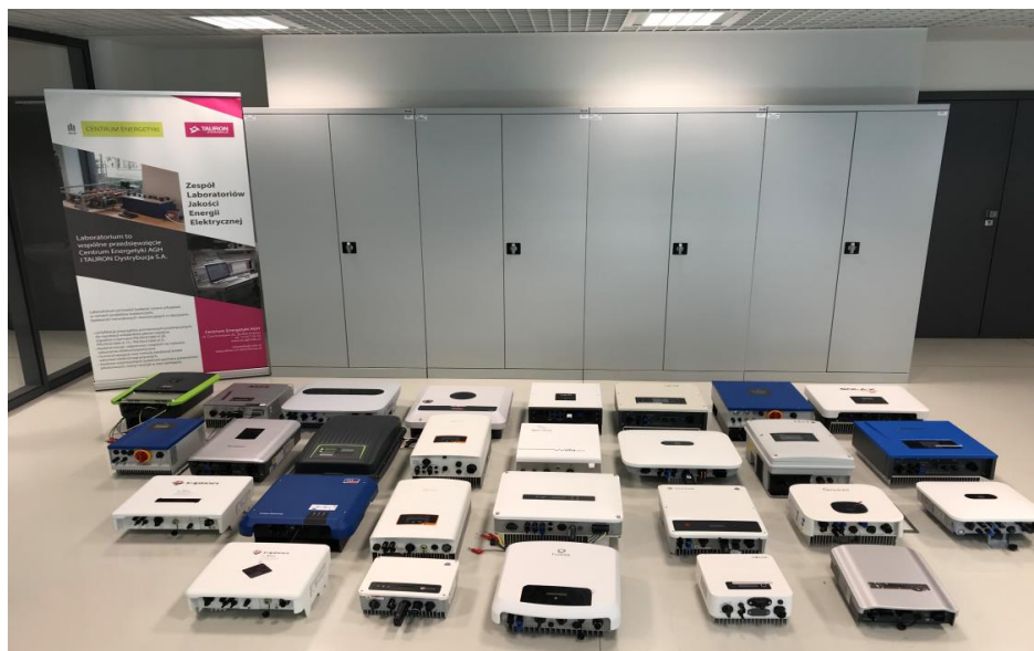
Rys. 5.1. Zbiórca prezentacja większości falowników mikroinstalacji fotowoltaicznych poddanych badaniom w ramach wydarzenia „Piknik OZE 2021” [97]
