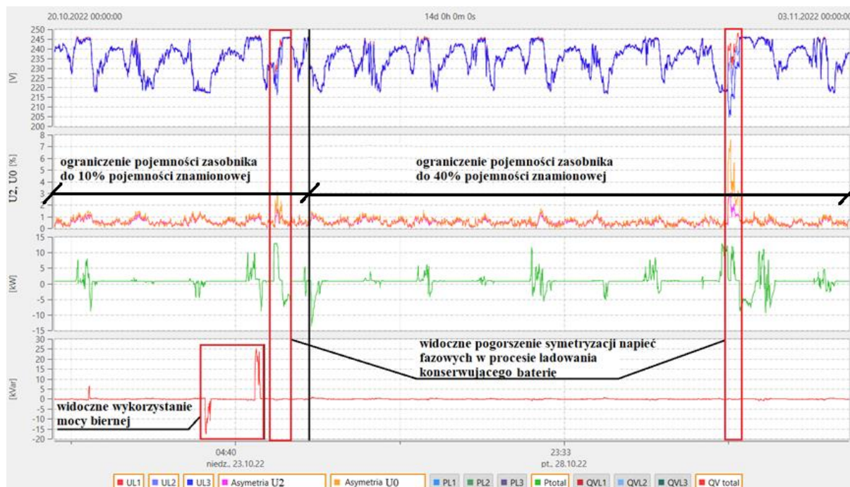
Rys. 7.36. Przebiegi agregowanych 10-minutowo profili wartości skutecznych napięć fazowych, współczynników asymetrii napięcia, trójfazowej mocy czynnej oraz biernej zmierzonych w punkcie M11 na wyjściu bateryjnego magazynu energii po ograniczeniu pojemności zasobnika do 10% oraz 40% jego pojemności znamionowej (okres 20.10-03.11.2022 r.)
