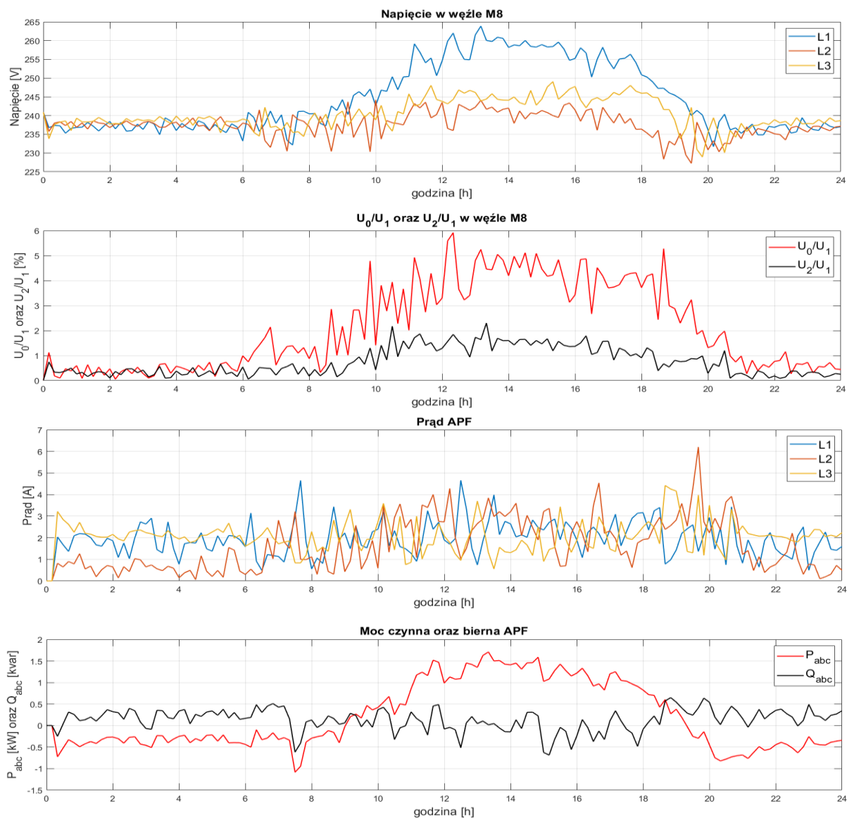
Rys. 7.18. Przebiegi wartości skutecznych napięć fazowych, współczynników asymetrii U_0/U_1 i U_2/U_1 , wartości skutecznych prądów fazowych, mocy czynnej i biernej filtra aktywnego w punkcie M8 dla przypadku pracy urządzenia w: (a) pełnej oraz (b) niepełnej konfiguracji
