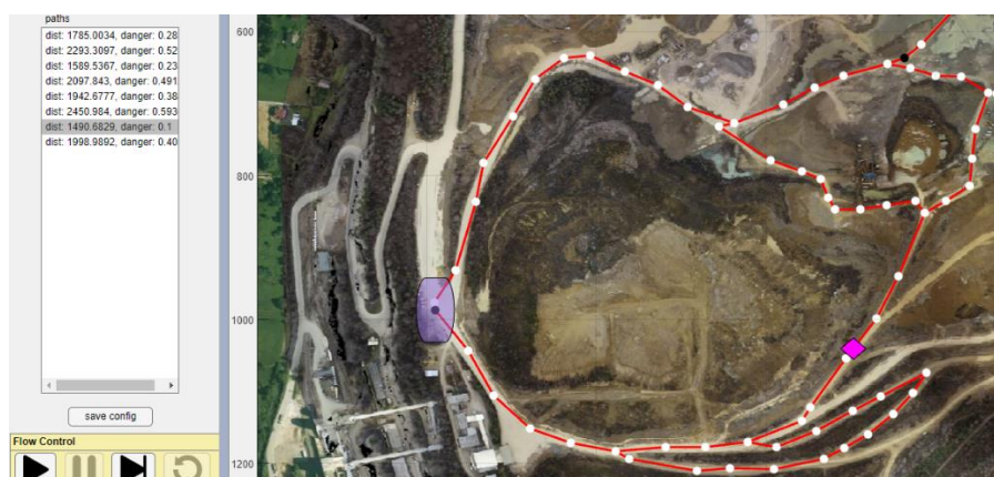
Rys. 10. Widok interfejsu aplikacji w trakcie symulacji ruchu ewakuowanego pojazdu.
