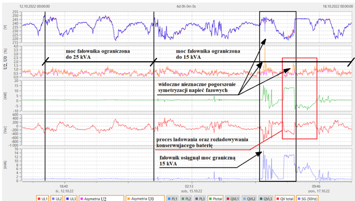
Rys. 7.49. Przebiegi agregowanych 10-minutowo profili wartości skutecznych napięć fazowych, współczynników asymetrii napięcia, trójfazowej mocy czynnej, bierniej oraz pozornej zmierzonych w punkcie M11 na wyjściu bateryjnego magazynu energii po ograniczeniu mocy falownika do 25 kVA i 15 kVA (okres 12-18.10.2022 r.)
