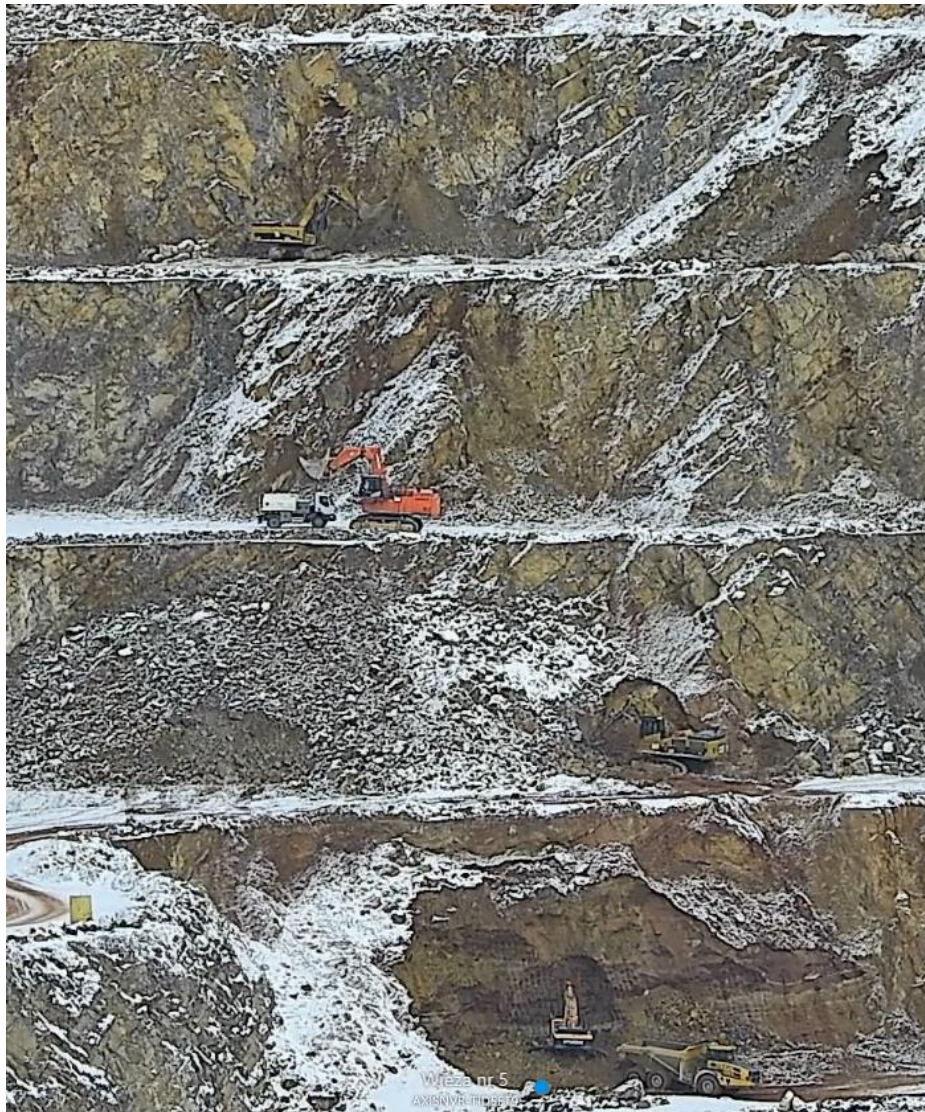
Rys. 12. Prace na kilku kolejnych poziomach eksploatacyjnych. Źródło: materiały własne KWC.
