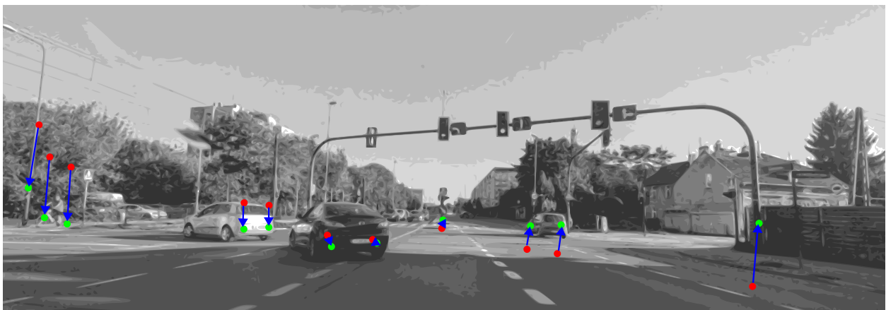
Rysunek 5: Ilustracja przedstawiająca wpływ przekrzywienia radaru na detekcje radarowe. Czerwone punkty przedstawiają detekcje radarowe naniesione na układ współrzędnych samochodu nie posiadającego informacji o przekrzywieniu radaru, zielone punkty oznaczają skorygowane detekcje, niebieskie strzałki oznaczają wektor korygujący detekcje.
