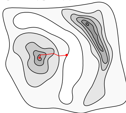
Rysunek 7.1: Mapa poziomicowa przykładowej funkcji celu z minimum lokalnym z lewej strony oraz minimum globalnym z prawej. Ciemniejsze obszary oznaczają mniejsze wartości. Czerwona linia oznacza kierunek optymalizacji lokalnej równania z wartością początkową oznaczoną kropką.
