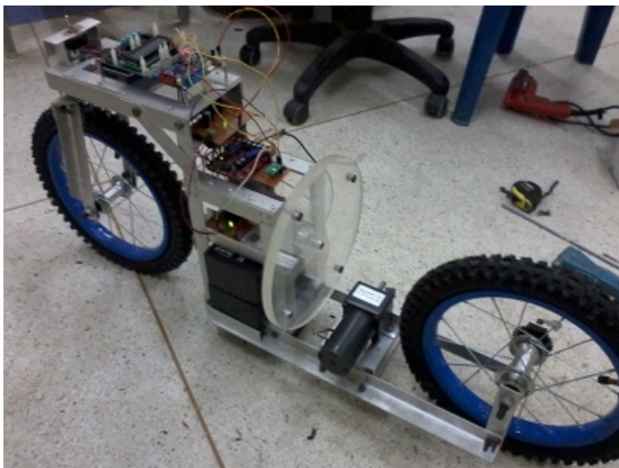
Rys. 2.4. Jednoślad z kołem reakcyjnym (ilustracja pochodzi z [59]).
